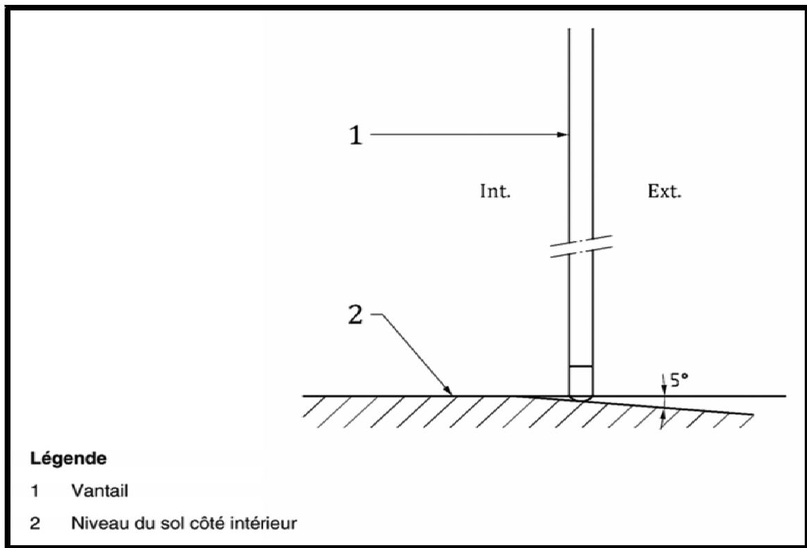
**La mise en œuvre de l'étanchéité périphérique ainsi que d'un dispositif d'évacuation des eaux stagnantes conformes aux exigences normatives sont bien sûr requis pour atteindre les performances revendiquées en résistance à la pénétration de l'air et de l'eau.**
